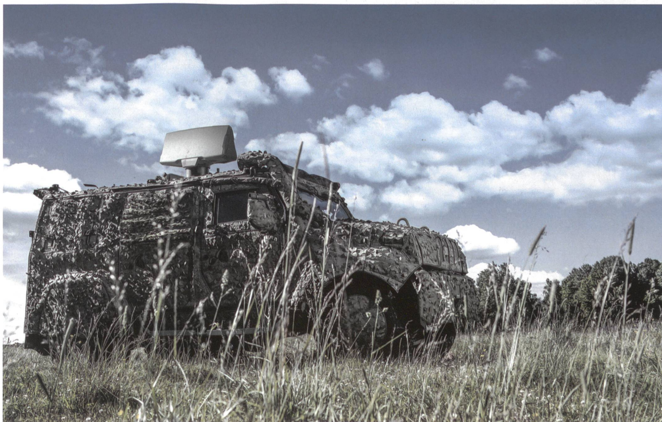
Radarsystem Giraffe: Einsatzmittel auf Flughäfen zur Identifizierung und Klassifizierung von Drohnen.
