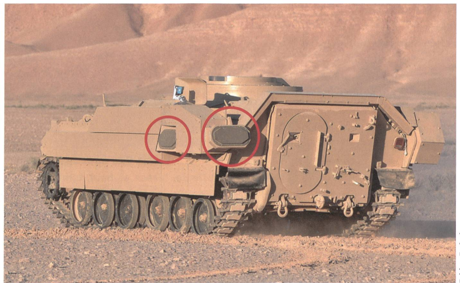
Trophy seitlich von hinten 2 x am Schützenpanzer Bradley (rote Kreise).
