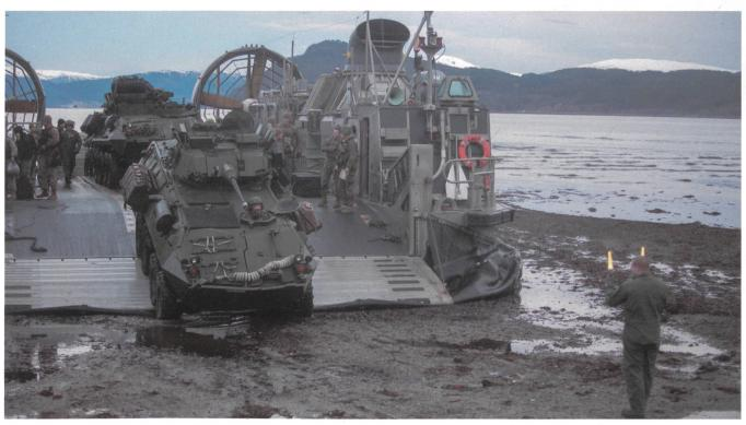
US Marines entladen bei Avlund Radschützenpanzer von einem Luftkissenfahrzeug (LCAC), das Material vom Docklandungsschiff USS New York (LPD 21) heranführt.
