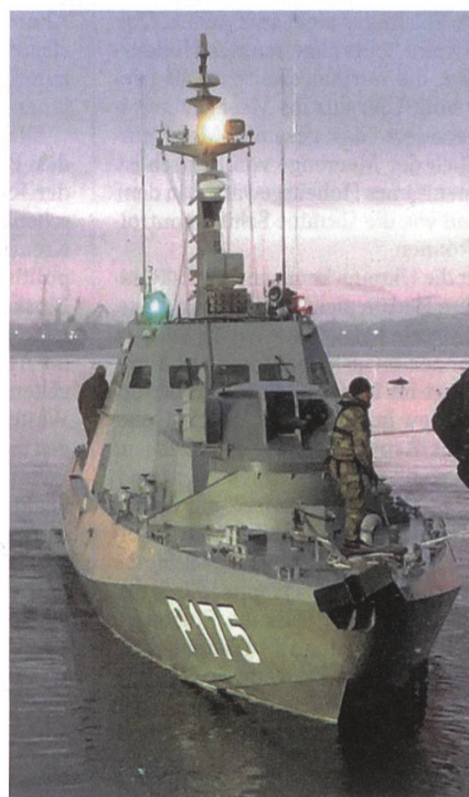
Oberst i Gst Jürg Kürsener: «Das Patrouillenboot P-175 verfügt vorne und achtern über je einen ferngesteuerten 30-mm-Zwilling (Turm, je zwei 30-mm-Grantwerfer, je zwei 6.6 MG).»
