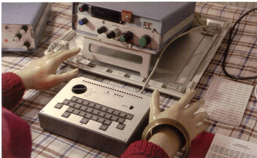
Kurzwellensender PHOENIX, getarnt als Schreibmaschine zur Heimabgabe.
