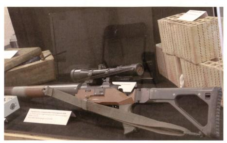
Spezialgewehr G150 mit Zielfernrohr und Schalldämpfer von SIG Neuhausen.
