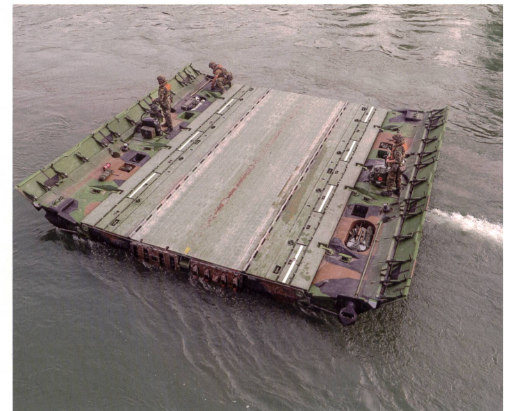
Drei Pontioniere bringen ein Modul der Schwimmbrücke in Position.
