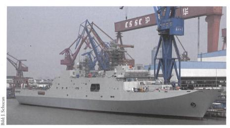
Zu den neuen amphibischen Einheiten gehören auch die Docklandungsschiffe des Typs 071, derzeit sind 7 Schiffe vorhanden. Diese Einheit der «Yuzhao»-Klasse hat in Shanghai festgemacht. Die Schiffe sind knapp 20 000 to gross, 210 m lang und können bis zu vier Luftkissenfahrzeuge des Typs 726 sowie bis zu 6 Helikopter mitführen.
