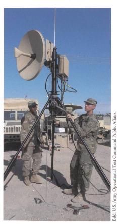
Das Richtstrahlsystem TRILOS bei einem US-Truppenversuch.
