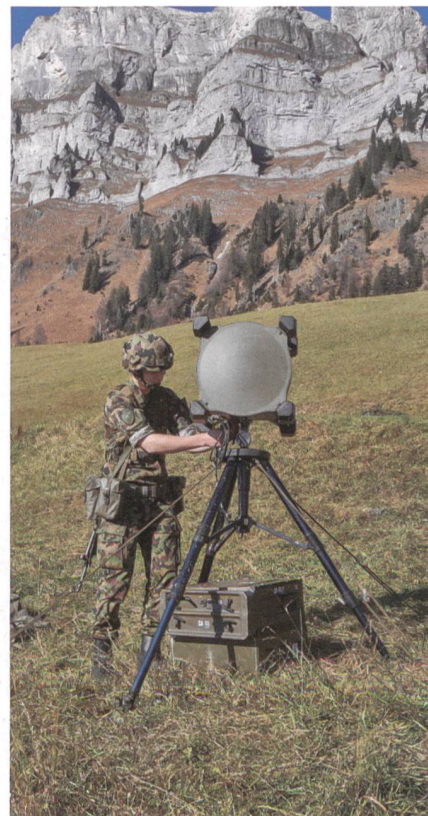
Das statisch eingesetzte Richtstrahlensystem R-905 der Schweizer Armee mit hoher Autonomie und Datendurchsatz.
