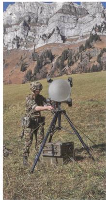
Das statisch eingesetzte Richtstrahlsystem R-905 der Schweizer Armee mit hoher Autonomie und Datendurchsatz.
