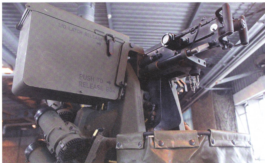
Die Waffenstation für den Nahbereich: Der Mörser-Kdt bedient das 12,7-mm-MG mit angebauten Nebelwerfern. Er setzt die Waffenstation ferngesteuert ein.
