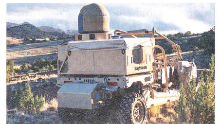
Lasergestütztes Drohnenabwehrsystem auf Polaris Geländefahrzeug.
