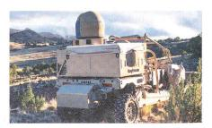
Lasergestütztes Drohnenabwehrsystem auf Polaris Geländefahrzeug.
