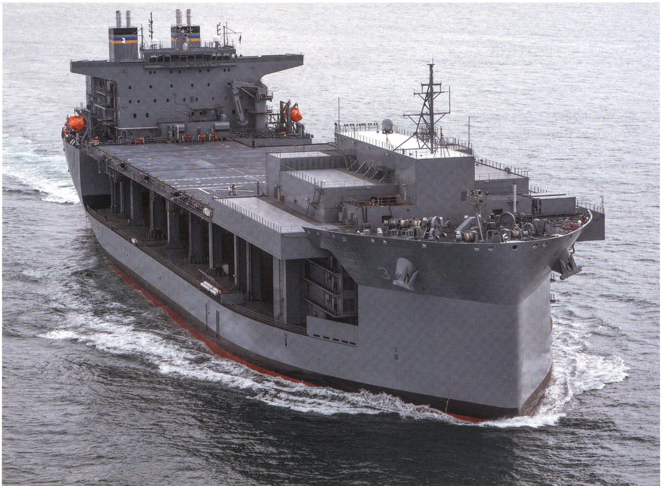
Ein Unikat sind die neuen «Expeditionary Sea Base» Einheiten wie hier die USNS «Lewis B. Puller» (T-ESB 3), die in Konfliktnähe und auf hoher See den Umschlag von Material von Transportschiffen auf Luftkissenfahrzeuge ermöglichen.
