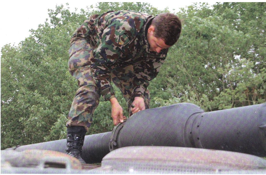
Wachtmeister Joel Knobel, Pz Kdt AMBOSS DUE, unmittelbar nach Abbruch des Clusters: Auf seinem Leo will das Rohr nicht so ganz ins Marschlager einrasten.
