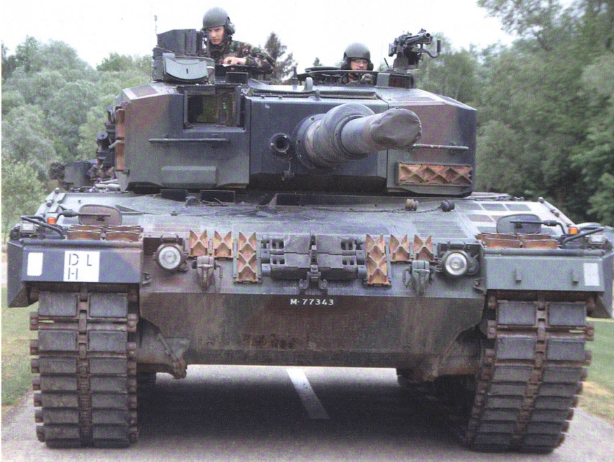
Leopard-2: 56,6 Tonnen Stahl mit der 120-mm-Glattrrohrkanone als Hauptwaffe. Oblt Ramon Schmid führt seinen Zug AMBOSS mit vier Kampfpanzern ins Gefecht.
