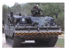
Der Bergepanzer Büffel wiegt 58,6 t. Anhängelast 63 t. Fährt 68 km/h.
