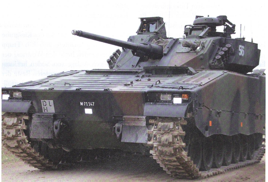
Schützenpanzer 2000 Hägglunds CV-9030, das Rückgrat der Panzergrenadierkompanien. Hauptwaffe: 30-mm-Maschinenkanone; plus 7,5-mm-MG und acht 7,6-cm-Nebelwerfer. V8-Scania-Motor 625 PS. Perkins-X-300-8CH-Getriebe. Wiegt 28,7 t. 11 Mann Besatzung: Kommandant, Richter, Fahrer und acht Panzergrenadiere.
