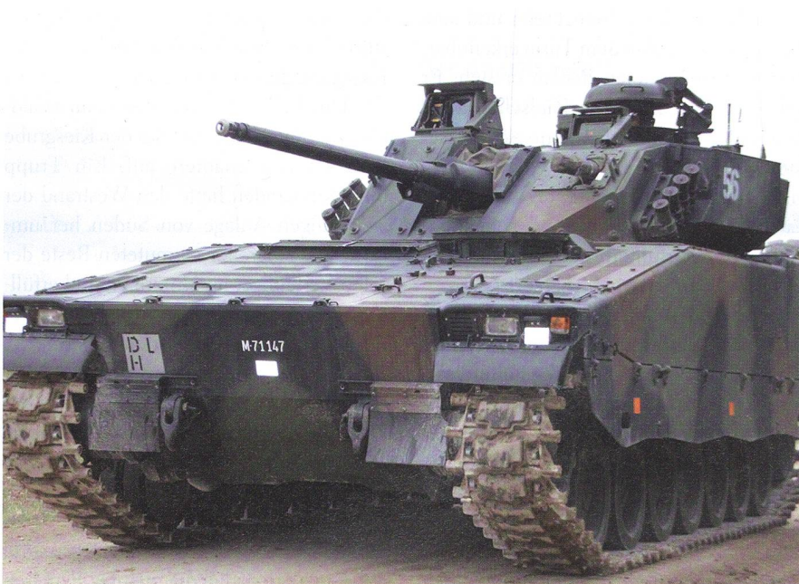
Schützenpanzer 2000 Hägglunds CV-9030, das Rückgrat der Panzergrenadierkompanien. Hauptwaffe: 30-mm-Maschinenkanone; plus 7,5-mm-MG und acht 7,6-cm-Nebelwerfer. V8-Scania-Motor 625 PS. Perkins-X-300-8CH-Getriebe. Wiegt 28,7 t. 11 Mann Besatzung: Kommandant, Richter, Fahrer und acht Panzergrenadiere.
