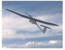
Minidrohne Fly Eye von WB Electronics.
