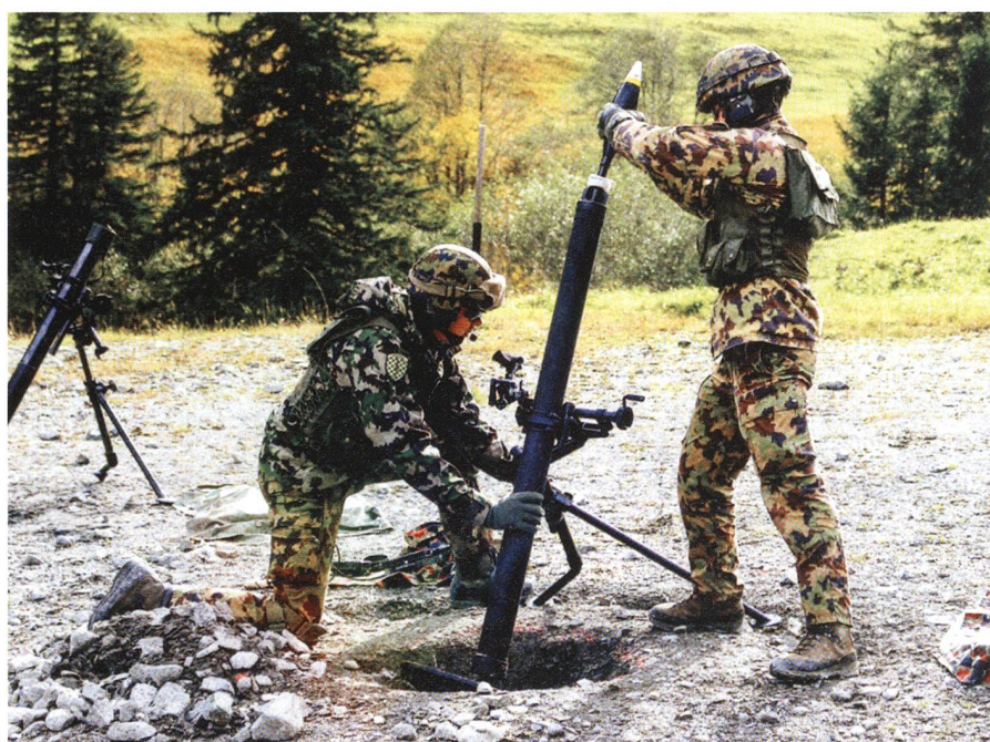
Die Granate wird ins Rohr eines der beiden getesteten Mörser eingeführt.
