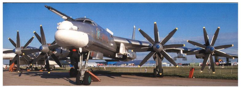
Der Fernbomber Tu-95 («BEAR»). Besitzt ein modernes Radar, eine mit der Satelliten-Navigation GLONASS kompatible Zielerfassung und trägt acht strategische Marschflugkörper vom Typ Ch-101 oder Ch-102-Raketen mit nuklearem Gefechtskopf.
