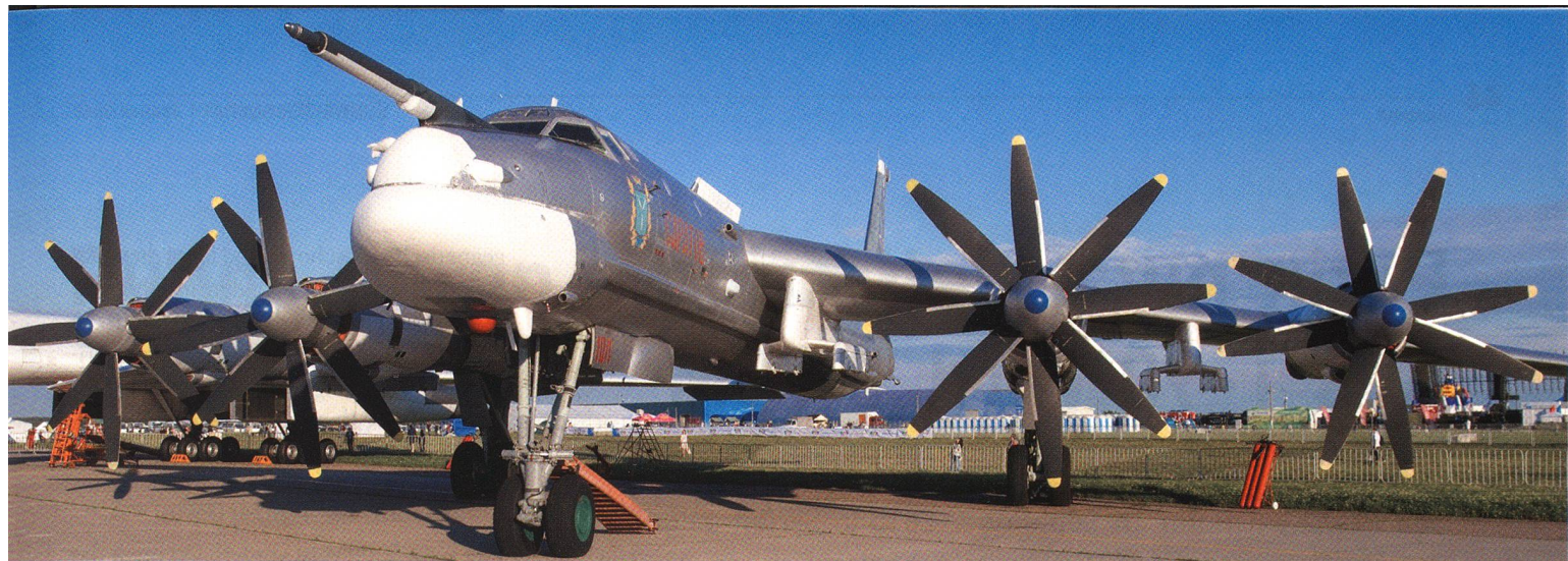
Der Fernbomber Tu-95 («BEAR»). Besitzt ein modernes Radar, eine mit der Satelliten-Navigation GLONASS kompatible Zielerfassung und trägt acht strategische Marschflugkörper vom Typ Ch-101 oder Ch-102-Raketen mit nuklearem Gefechtskopf.
