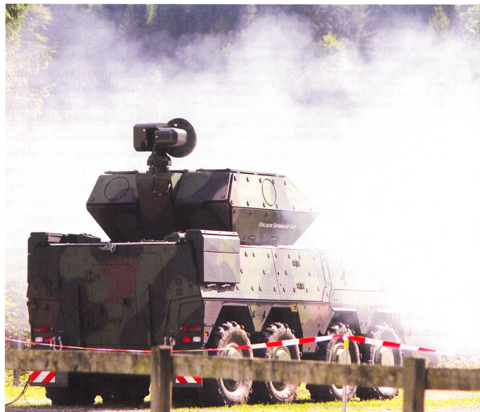
Der Schützenpanzer Boxer, ausgerüstet mit der Skyranger Mk 4 35 mm Kanone, beim scharfen Schuss auf eine anfliegende Drohne auf dem Gelände des Ochsenbodens.
