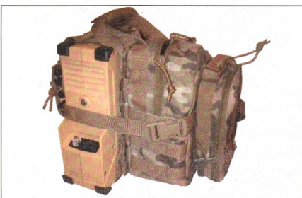
Brennstoffzelle SFC Jenny 1200.
