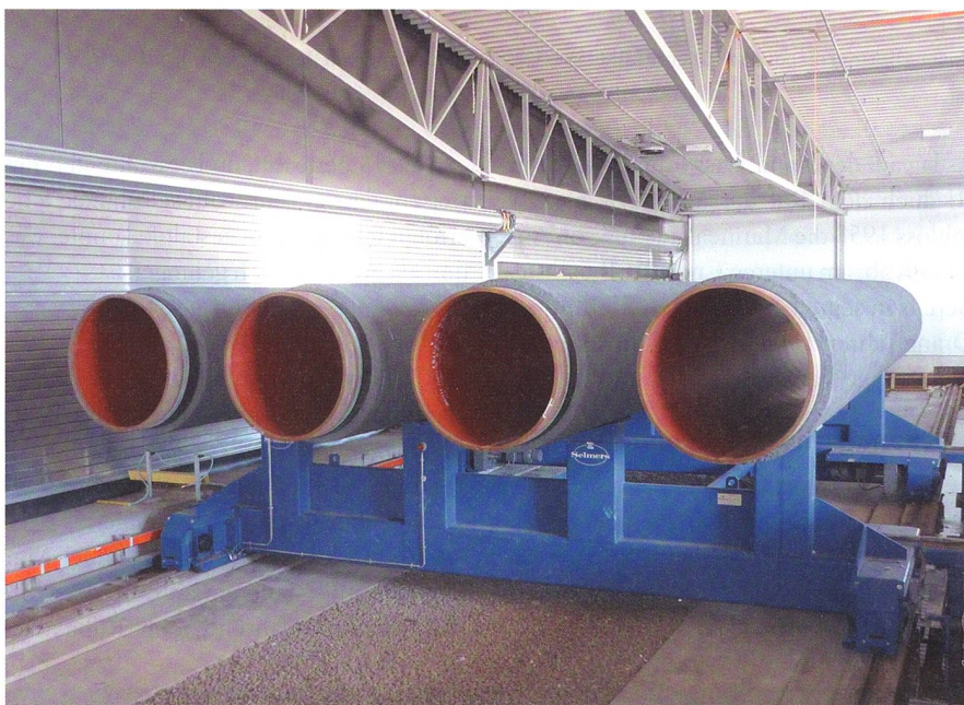
Länge der Rohre: 12 m. Länge jeder Leitung: 1224 km. Insgesamt 199 755 Rohre. Innendurchmesser 1153 mm. Rohr wiegt 24 t. Es wurden 2 424 000 t Stahl verbaut.
