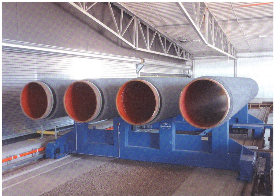
Länge der Rohre: 12 m. Länge jeder Leitung: 1224 km. Insgesamt 199 755 Rohre. Innendurchmesser 1153 mm. Rohr wiegt 24 t. Es wurden 2 424 000 t Stahl verbaut.
