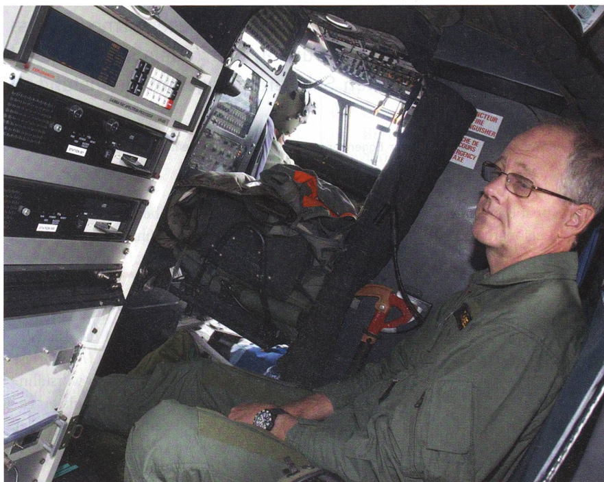
Mit dieser Konsole werden die Messdaten zur späteren Auswertung aufgezeichnet.
