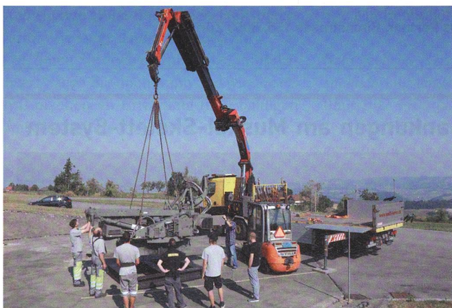
Der Pneukran hebt den Werfer an.
