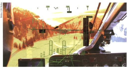
Der Heli wird von einem Piloten im rechten Sitz gesteuert. Hptm Hügli testet das System auf dem linken Sitz. Zur Visualisierung ist eine orange Folie aufgeklebt.
