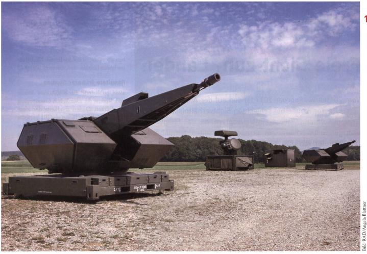
«Oerlikon Skyshield® Air Defence System: allwettertaugliches Luftverteidigungssystem für den Nahbereichsschutz, bestehend aus zwei unbemannten Revolvergeschützen, einer unbemannten Sensoreinheit und einem abgesetzten Kommandoposten.»
