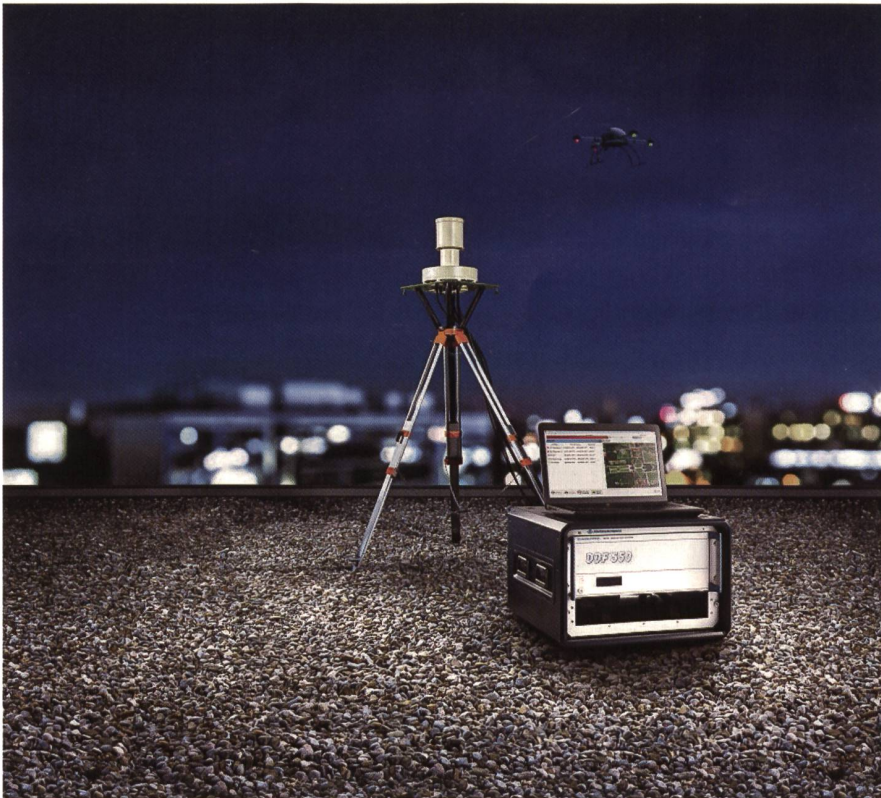
Das leicht zu transportierende ARDRONIS-System mit Laptop, Peilempfänger DDF550 und Peilantenne auf dem Stativ installiert auf einem Hausdach.
