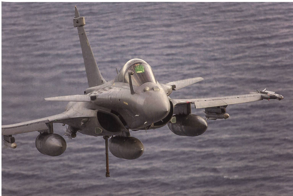
Ein Kampfflugzeug Rafale der französischen Marine im Landeanflug auf den Flugzeugträger Charles de Gaulle. Gut sichtbar ist der ausgefahrene Fanghaken am Heck, er bringt die Maschine auf dem Deck innerhalb weniger Meter zum Stillstand.
