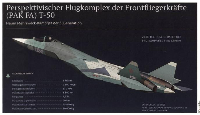
Der Hersteller Suchoi, der in Russland MiG den Rang abläuft, nennt für den T-50 die Höchstgeschwindigkeit von 2600 km/h.
