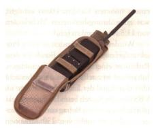
Störgerät gegen Sprengfallen für die deutsche Bundeswehr von Thales.
