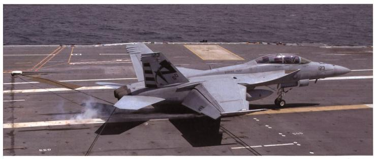
Am 28. Juli 2017 führte Korvettenkapitän Jamie Struck die ersten Katapultstarts und Fangseillandungen mit einer F/A-18F Super Hornet der Versuchsstaffel VX-23 auf der Ford durch. Hier die erste Landung am Fangseil Nr. 2.
