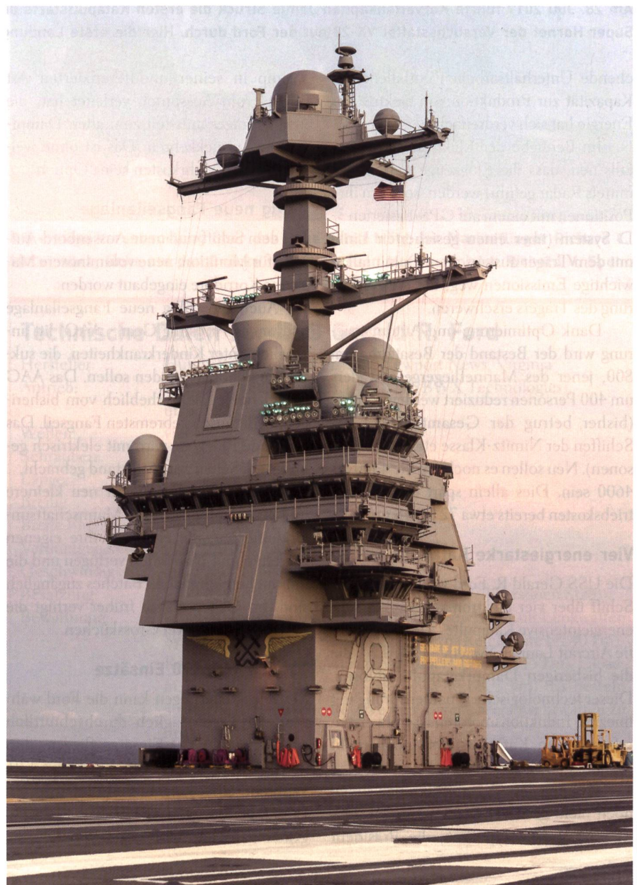
Der Kommandoturm der Ford unterscheidet sich von Inseln früherer Träger. Er ist kleiner, abgeschrägt und nach hinten versetzt. Er hat nur einen Mast.
