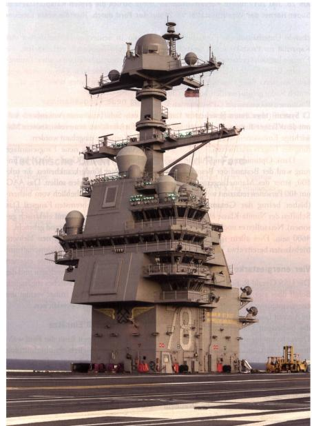
Der Kommandoturm der Ford unterscheidet sich von Inseln früherer Träger. Er ist kleiner, abgeschrägt und nach hinten versetzt. Er hat nur einen Mast.
