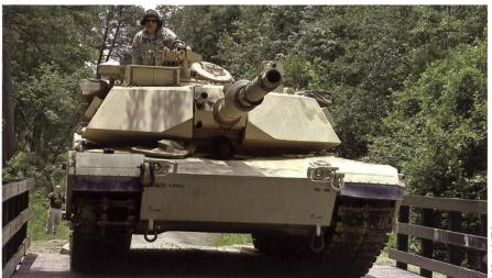
Der amerikanische Hauptkampfpanzer, der M1A2 Abrams von General Dynamics Land Systems, wiegt 65 Tonnen. 120-mm-Glattrohrkanone plus Maschinengewehre. 72 km/h. Vier Mann Besatzung: Kommandant, Richtschütze, Lader, Panzerfahrer.
