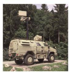
Bodenüberwachungsradar Spexer 2000.
