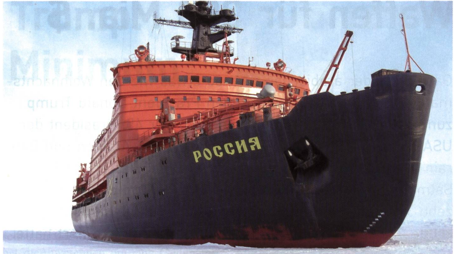
Die Rossiya (Russland) ist der zweitgrösste Eisbrecher der Welt und hat eine Wasserverdrängung von 22 920 Tonnen, Atomtrieb und eine Maschinenleistung von 75 000 PS. Das Schiff benötigt bei 10 Knoten Fahrt 300 Gramm Uran/Tag.
