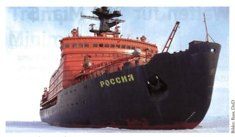
Die Rossiya (Russland) ist der zweitgrösste Eisbrecher der Welt und hat eine Wasserverdrängung von 22 920 Tonnen, Atomantrieb und eine Maschinenleistung von 75 000 PS. Das Schiff benötigt bei 10 Knoten Fahrt 300 Gramm Uran/Tag.
