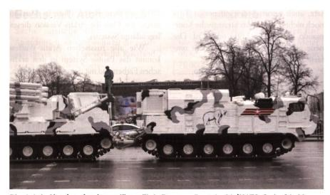
Die Arktis-Version des legendären Flab-Panzers Pantsir-S1 (NATO-Code SA-22 Greyhound). Der Pantsir der Waffenschmiede Ulyanoswk verbindet das Boden-Luft-Raketensystem 95Ya6 mit zwei 30-mm-Flab-Kanonen 2A38M von KBP Tula. Auch dieses Waffensystem kann bei 40 Grad unter Null eingesetzt werden.
