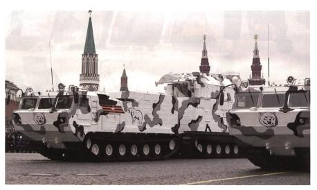
Der Arktis-Transporter Chetra TM-140A führt zusätzlich zur Besatzung acht Soldaten oder bis zu 1000 kg Fracht mit sich. Das Fahrzeug wiegt 11 200 kg, erreicht 45 km/h und hat eine Reichweite von 550 km. Es wird von der 250-PS-Gasturbine YaMZ-236-B2 angetrieben und hält Temperaturen bis zu 40 Grad unter Null aus.
