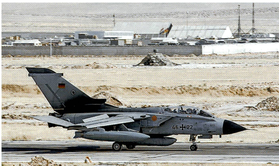
Recce-Tornado der Bundeswehr. Unter dem Rumpf das digitale Aufklärungssystem.
