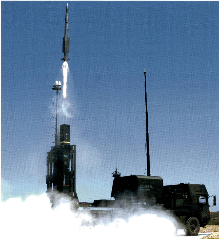
Abschuss der IRIS-T SL vom Startgerät, das total acht Raketen ins Gefecht führt.
