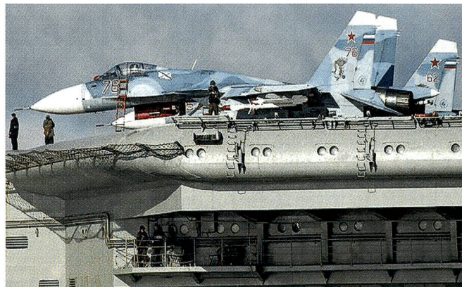
An Bord der Admiral Kuznetsov befinden sich neben einer grossen Zahl von Helikoptern 16 Kampfflugzeuge, darunter 8 bis 10 der abgebildeten Su-33 Flanker D.
