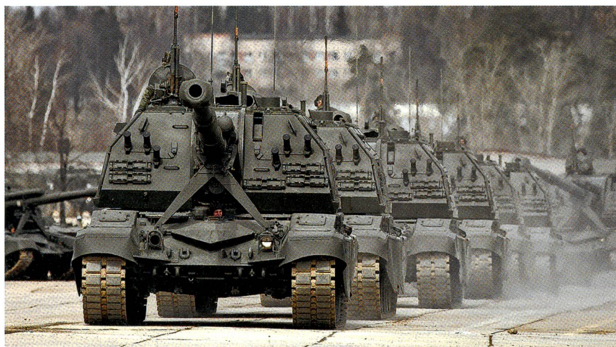
Die Standard-Panzerhaubitze 2S19 Msta-S, mit einer Kadenz von acht Schuss/Minute.
