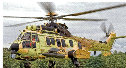
Versuchsträger mit Waffenstation HForce.
