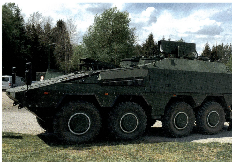
Das gepanzerte Transport-Kraftfahrzeug Boxer dient als Testplattform für die Laserkanone (HEL: High Energy Laser). Die Laserkanone ist gut sichtbar oben angebracht. Die notwendige Energieherstellung findet im Innenraum des Boxers statt.
