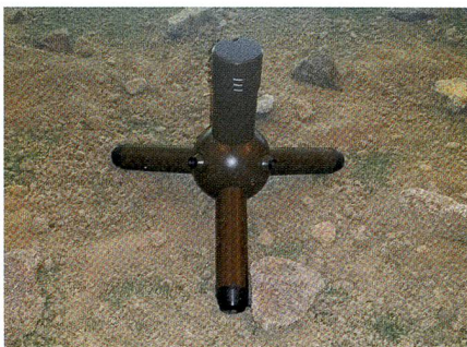
Sensor B-Saved zur Überwachung.
