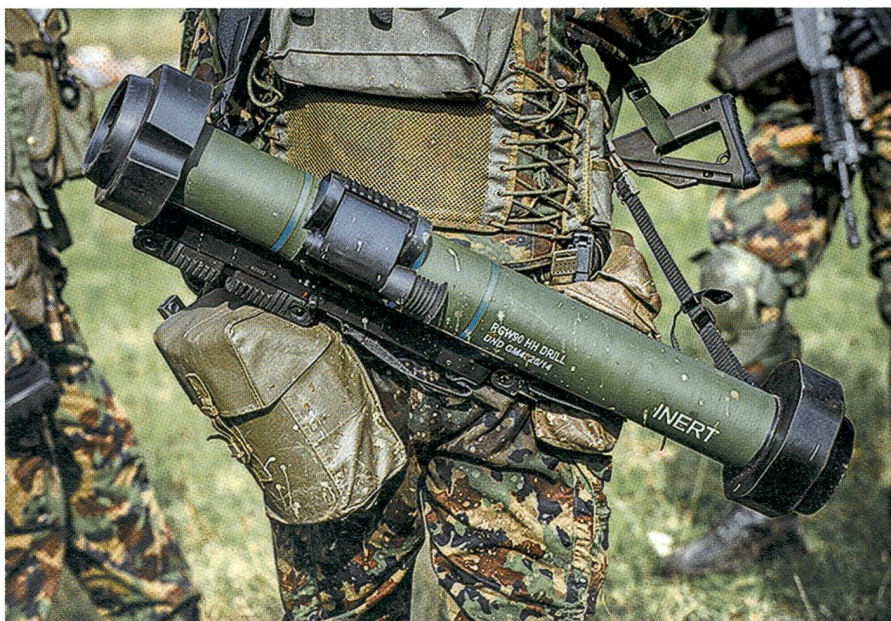
Eine der drei schultergestützten Mehrzweckwaffen ist die RGW 90 HH von Dynamit Nobel Defence. Sie wiegt ca. neun Kilogramm und kann bis 300 Meter Entfernung eingesetzt werden.
