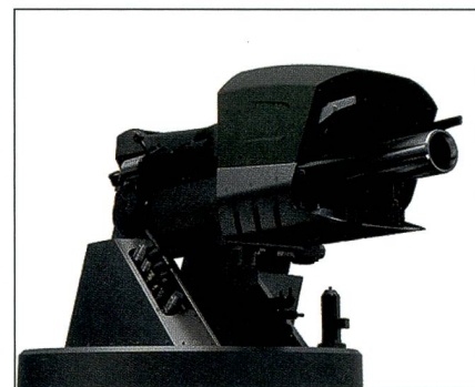
Das drehbare Rohr des 12-cm-Mörser.
