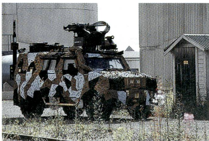
Tarnsystem Barracuda von Saab für die neuen Aufklärungsfahrzeuge Scout SV.
