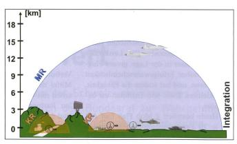
Luft- und bodengestützte Sensoren und Effektoren wirken im Rahmen der integrierten Luftverteidigung im gleichen Raum zur gleichen Zeit. Die zentrale Feuerführung erlaubt den Einsatz des am besten geeigneten Wirkmittels. Als technische Rückfallposition bleibt die autonome Feuerführung sowohl am Boden als auch in der Luft bestehen.
