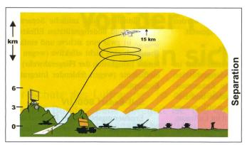
Die heutigen Fliegerabwehr-Systeme wirken bis auf 3000 Meter über Grund. Darüber hinaus sind die luftgestützten Mittel für die Luftverteidigung zuständig. Zudem sind die Flab-Sensoren von der Luftraumüberwachung separiert. Sie leisten somit keinen Beitrag zur zentral erkannten und identifizierten Luftlage, was ein Nachteil ist.
