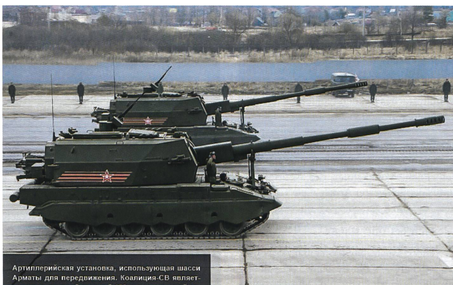
Das neue russische Geschütz Koalizija-SW mit einem Rohr auf dem Armata-Chassis.
