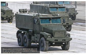
Transportfahrzeug Ural Typhoon von Kamaz. 21 t. Starker Minenschutz. 2 Mann Besatzung. Führt Mot-Schützen mit sich.
