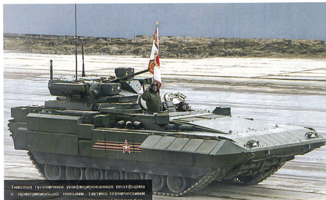
Der T-15 Armata. 2 Mann Besatzung, 8 Mot-Schützen. 40 Tonnen. 30-mm-Kanone, 4 x Kornet-EM, 1 x 7,62-mm-MG. Erzielt 70 km/h, reicht 550 km weit, 1200 PS. Überwindet 280 cm.
