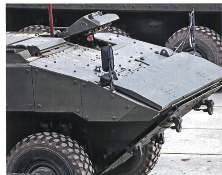
Die Schottpanzerung des Radschützenpanzers Bumerang. Oben der Fahrer mit geöffneter Luke. An der Parade fuhrten die Bumerang mit offenen Luken.
