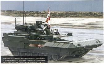
Der T-15 Armata. 2 Mann Besatzung, 8 Mot-Schützen. 40 Tonnen. 30-mm-Kanone, 4  $\times$  Kornet-EM, 1  $\times$  7,62-mm-MG. Erzielt 70 km/h, reicht 550 km weit, 1200 PS. Überwindet 280 cm.
