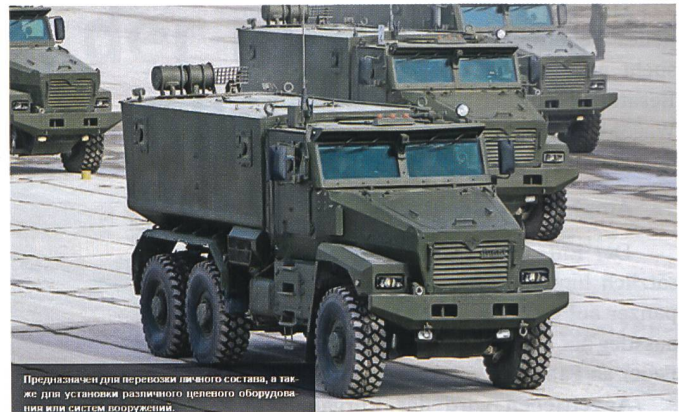
Transportfahrzeug Ural Typhoon von Kamaz. 21 t. Starker Minenschutz. 2 Mann Besatzung. Führt Mot-Schützen mit sich.
