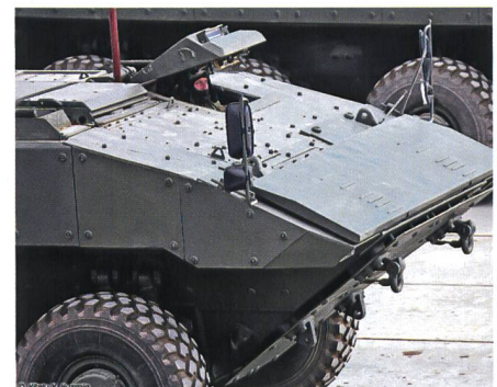
Die Schottpanzerung des Radschützenpanzers Bumerang. Oben der Fahrer mit geöffneter Luke. An der Parade fuhr die Bumerang mit offenen Luken.
