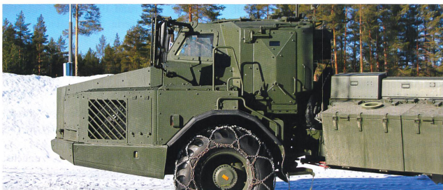
Gepanzerte Kabine des ARCHER bietet Schutz für Fahrer und Geschützbedienung.
