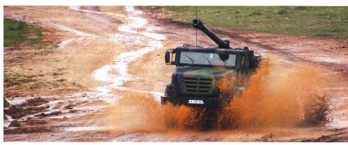
Der CAESAR MK II basiert auf einem Chassis von Renault - hier als Prototyp mit nur einer Antenne.
