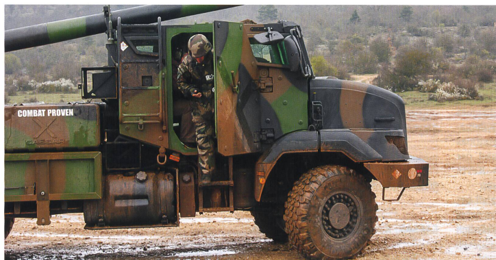
Während der Verschiebung ist die Besatzung in der gepanzerten Kabine untergebracht.
