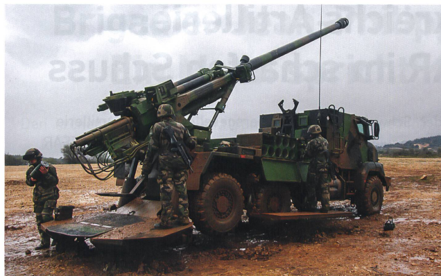
Für das Schiessen wird das Fahrzeug auf dem Erdsporn abgestützt.
