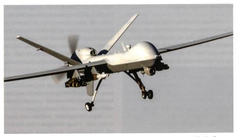
Eine mit Luft-Boden-Lenkwaffen ausgerüstete, bewaffnete Drohne der US Air Force. Eine in Afghanistan eingesetzte Drohne kann in den USA gesteuert werden.
