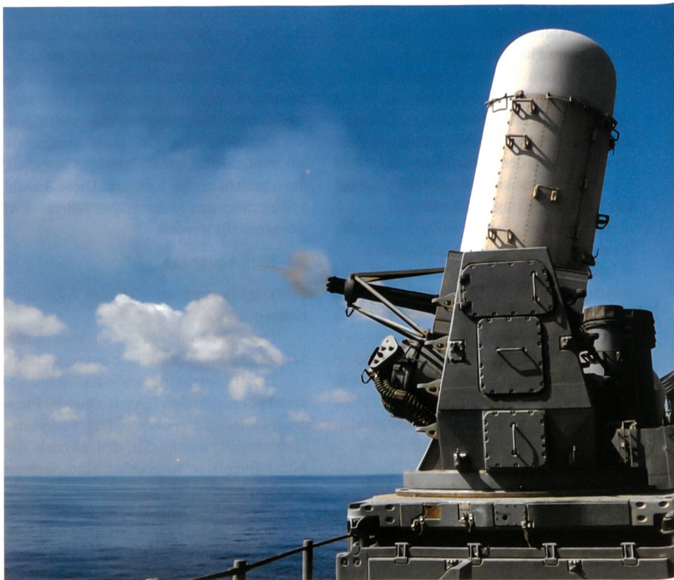
Um ihre Schiffe gegen anfliegende Anti-Schiff-Lenk Waffen schützen zu können, setzt die US Navy das Phalanx-System ein. Bei diesem sogenannten Close-in Weapon System (CIWS) handelt es sich um eine Kombination einer 20-mm-Gatling-Kanone mit einem Such- und Verfolgungsradar. Es kann autonom agieren.
