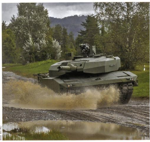
Auf dem Kampfpanzer Leopard ist das sogenannte SidePRO-ATR passive Schutzsystem der RUAG Defence montiert. Es schützt gegen Panzerabwehrwaffen wie RPG-7, gegen KE-Munition (Wuchtgeschosse) und gegen panzerbrechende Munition.
