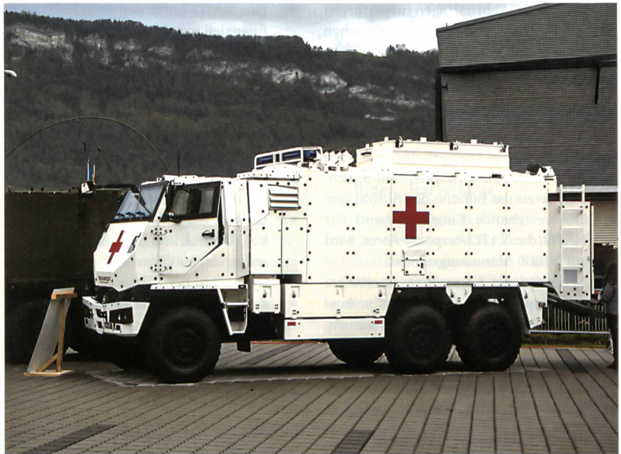
Das moderne gepanzerte Sanitätsradfahrzeug 6x6, unverkennbar ein Duro von MOWAG.
